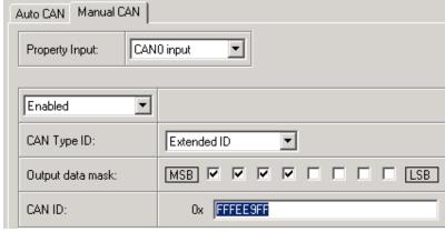
Figure 58 CAN parameter configuration example
