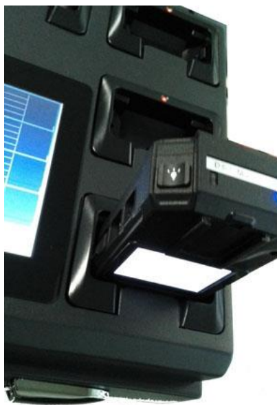
Рисунок 18. Установка МАРВ в разъем терминала
