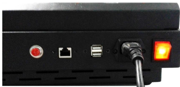
Рисунок 6. Включение питания, проверка индикации выключателя
