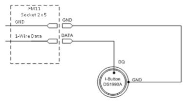
Figure 9 I-Button DS1990A connection scheme
