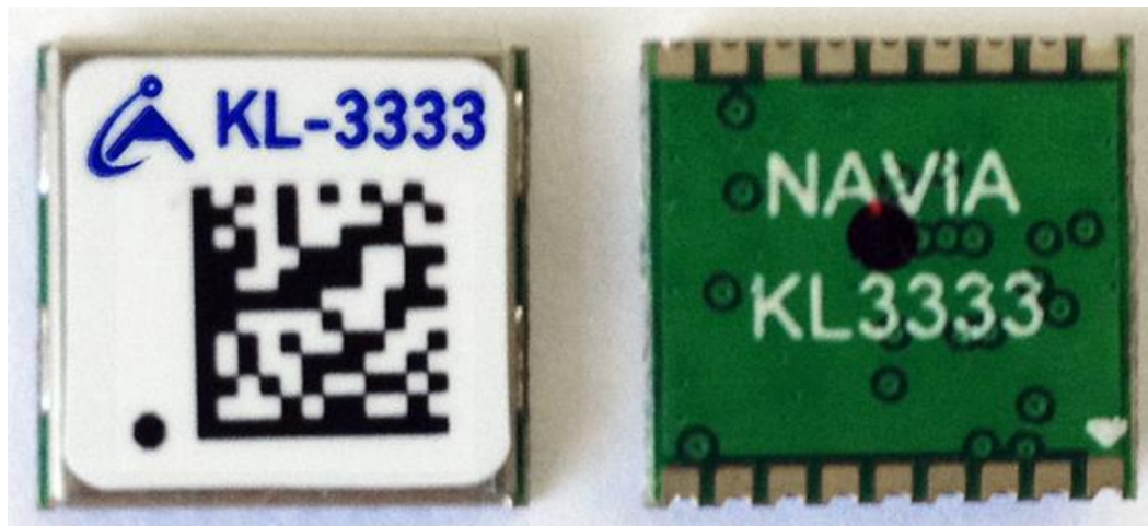
Рис. 7. Внешний вид приемника KL3333 сверху и снизу (не в масштабе 1:1).
