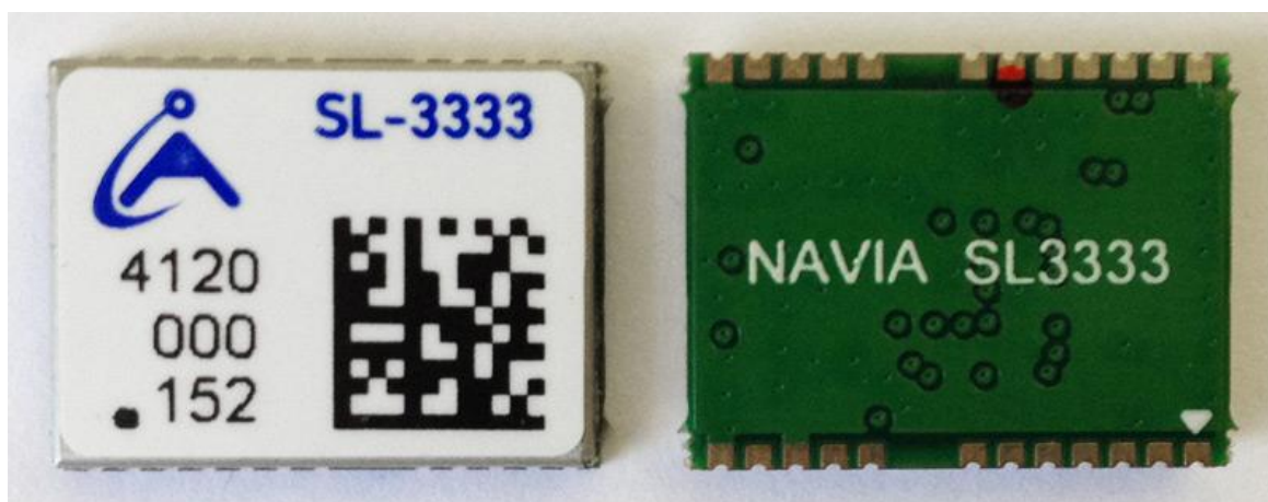
Рис. 8. Внешний вид приемника SL3333 сверху и снизу (не в масштабе 1:1).
