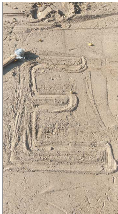
Рис. 13. Навигационный стилус с антенной перемещается по границам буквы «Е»
