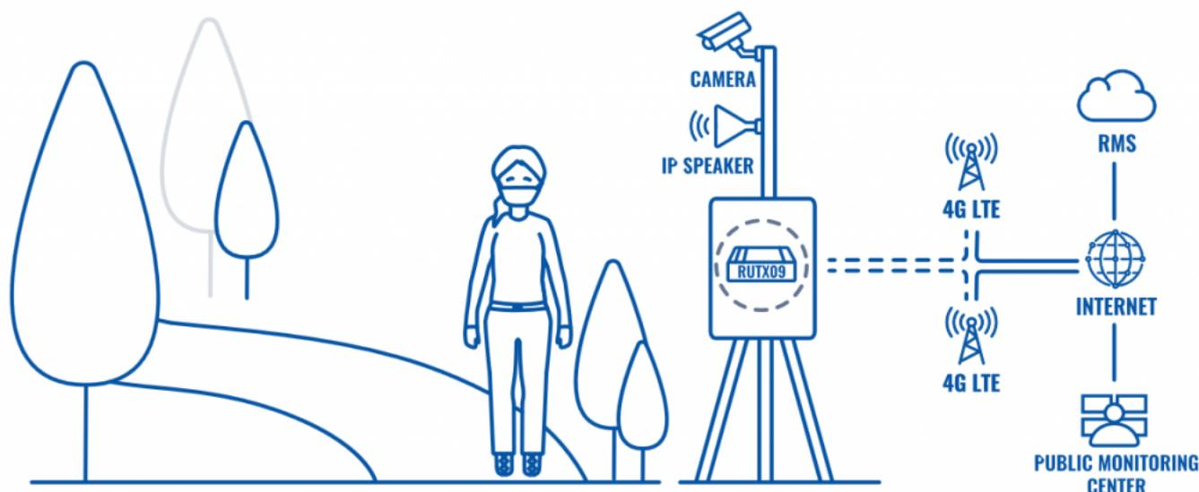
Узел наблюдения и оповещения снабжается профессиональным маршрутизатором RUTX09, работающим в системе сотовой связи четвертого поколения.
