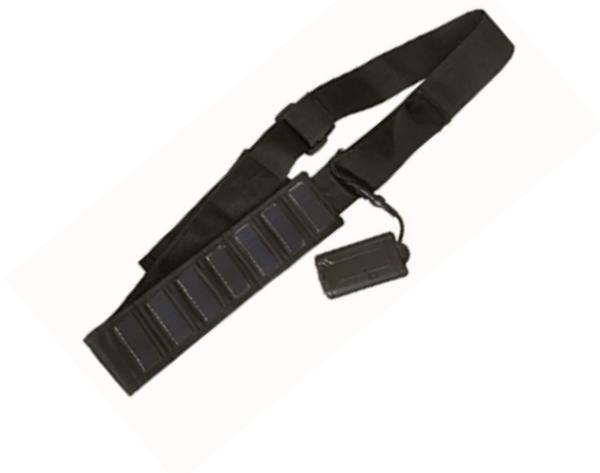
Водонепроницаемый GPS-трекер для животных Kingneed T500 с перезаряжаемым литий-полимерным аккумулятором и солнечными батареями для подзарядки, датчиком снятия и регулируемым ошейником для коров, лошадей и других животных
