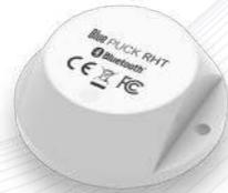
**Датчик температуры и влажности BLE**
