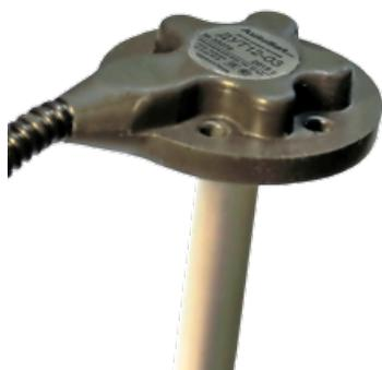
Датчик Автосат 12-03 обеспечивает высокоточное измерение уровня топлива и передачу измеренного значения в бортовой контроллер спутникового мониторинга по цифровому интерфейсу RS-485, либо при подключении к аналоговому, частотному или широтно-импульсному входу. Погрешность измерений - менее 1%.
