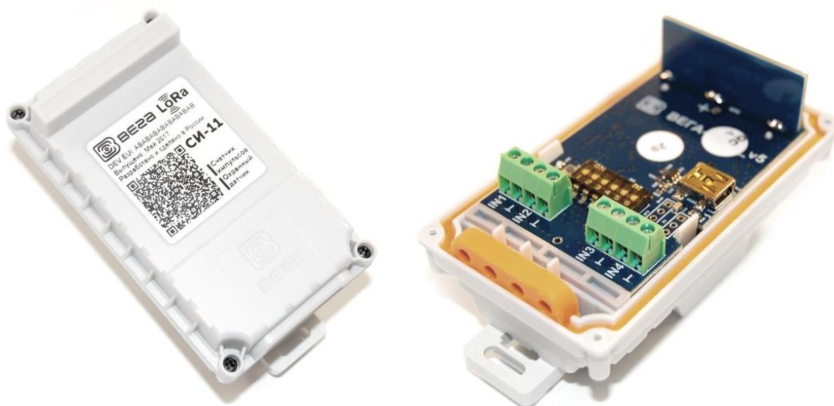
Элементом питания для счетчика служит встроенная батарея ёмкостью 3400mAh, рассчитанная на срок службы до 10 лет при передаче данных один раз в сутки.
