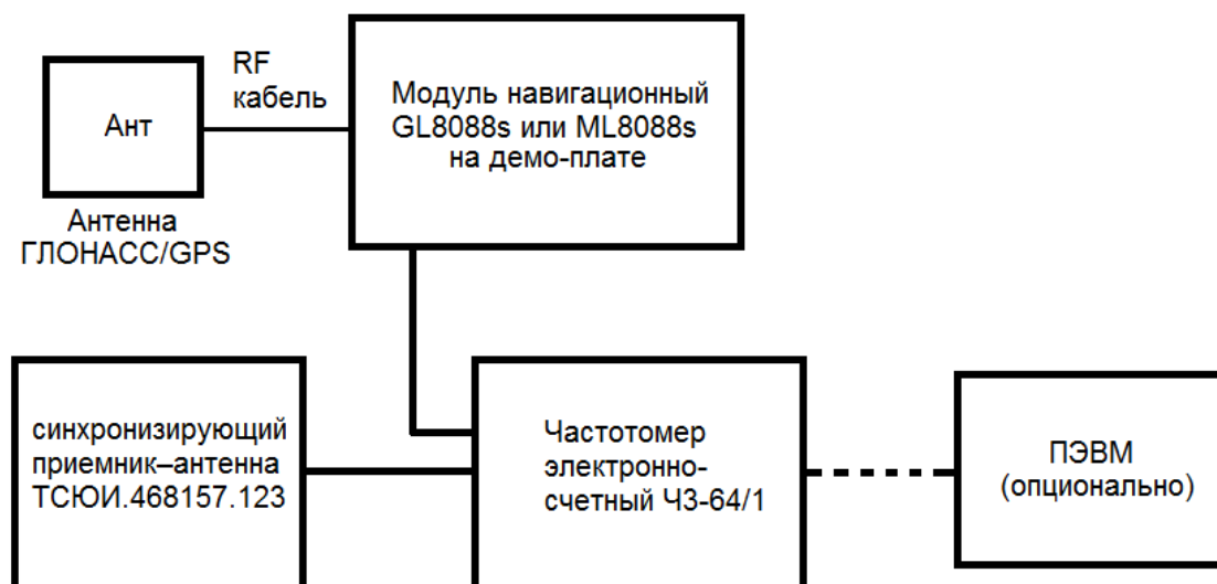
Рис. 11 Схема подключения аппаратуры для изменения параметров сигнала временной привязки 1PPS.
