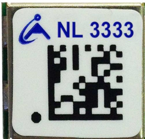
Рис. 2. Внешний вид приемника навигационного NL3333 (не в масштабе 1:1)
