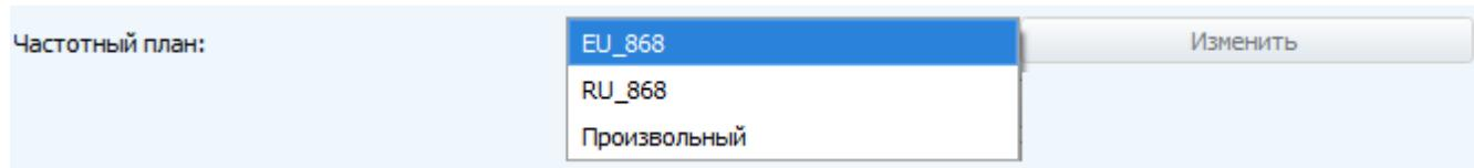
Счётчик импульсов поддерживает следующие частотные планы:
