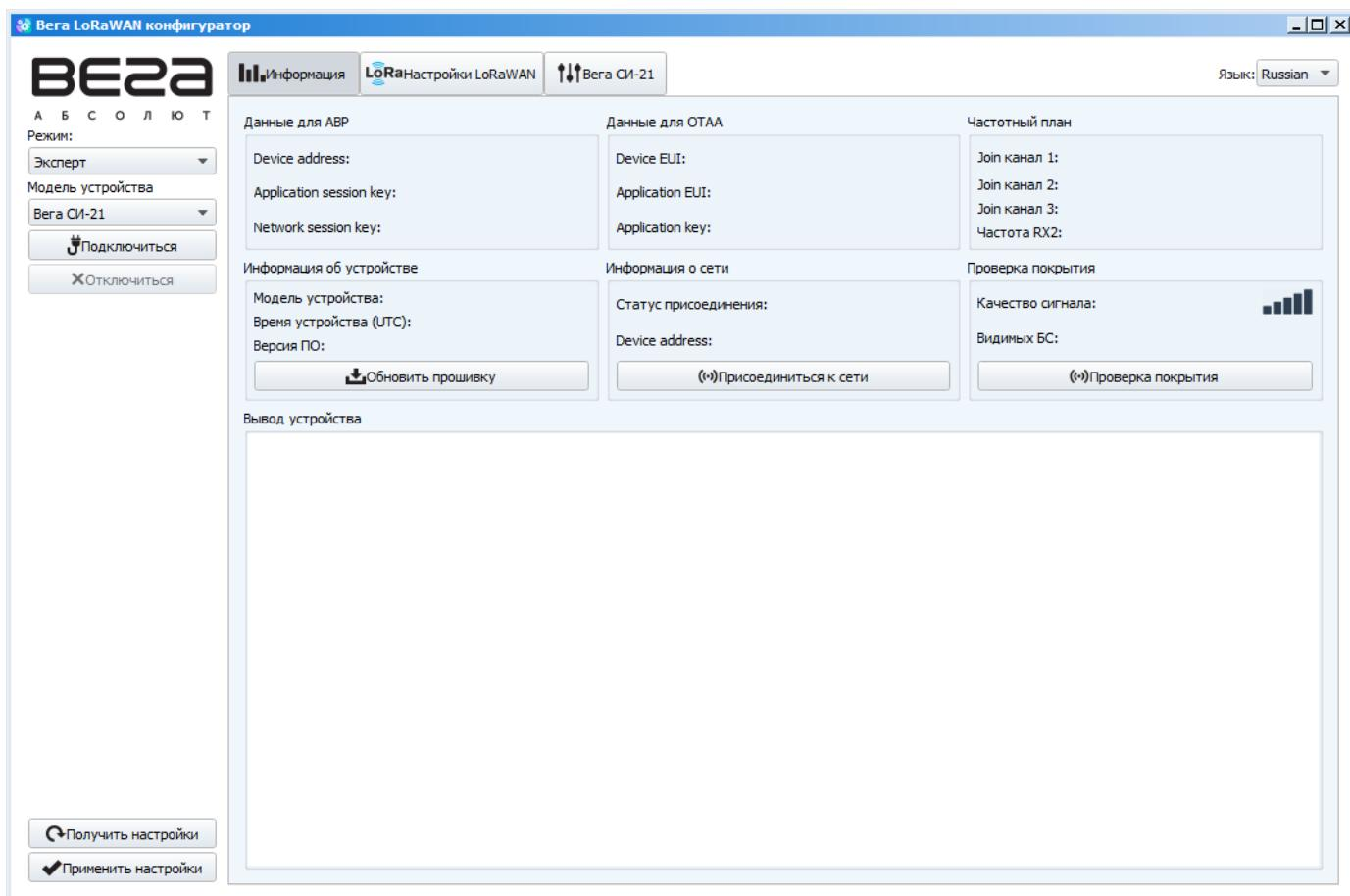
Меню слева позволяет переключаться между режимами работы программы «Простой» и «Эксперт», выбирать модель устройства, осуществлять подключение к устройству или отключиться от него, получать и применять настройки.
