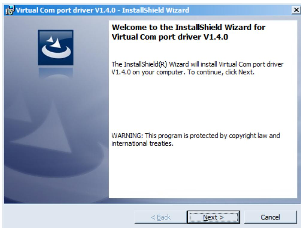
В этом окне нужно нажать кнопку **Next**, затем **Install**, после чего начнётся установка. По окончании появится окно успешного завершения установки:
