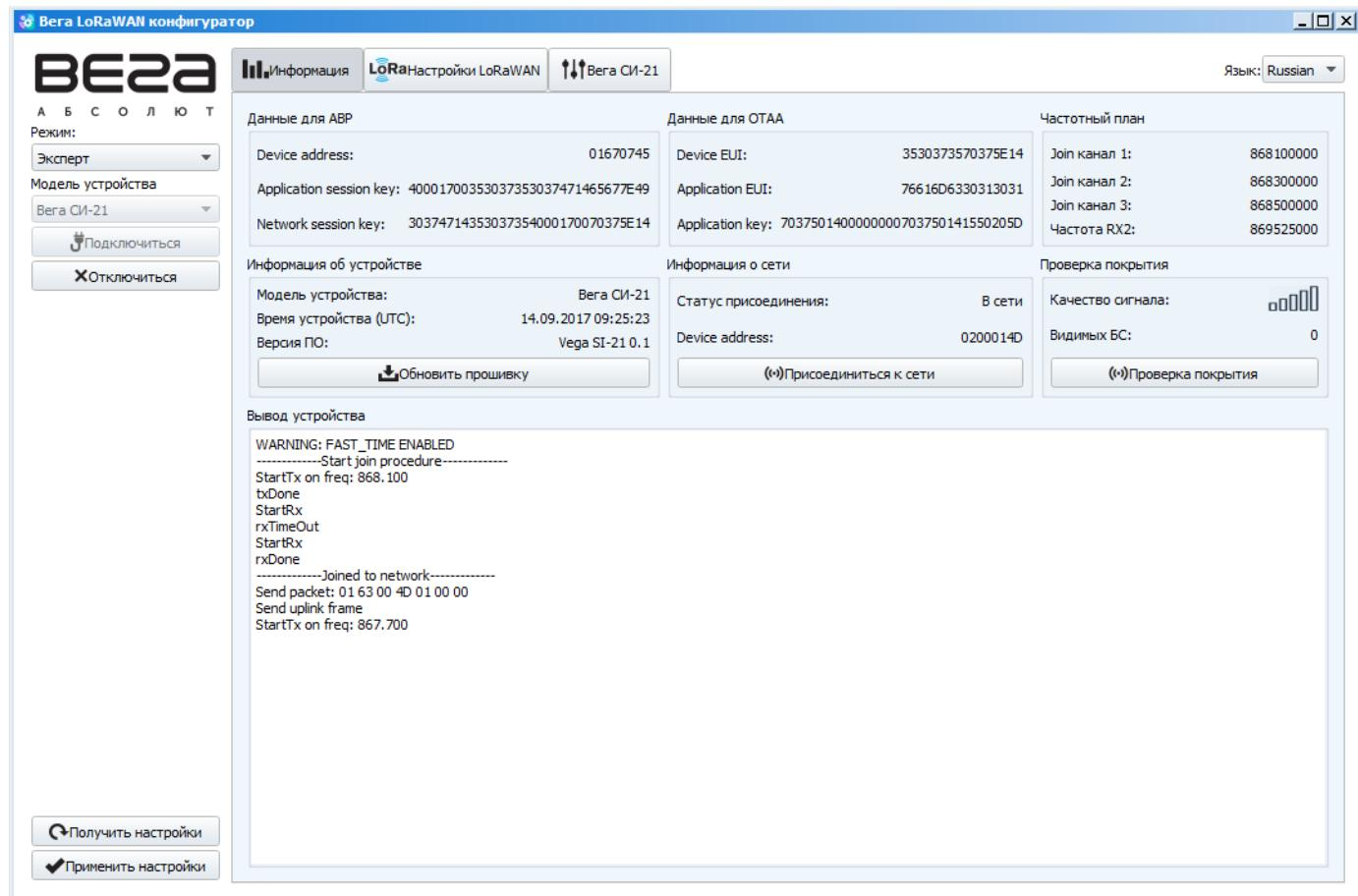
Для считывания настроек с устройства нужно нажать кнопку «Получить настройки», до этого момента в программе будут отображаться настройки по умолчанию или с последнего подключенного устройства.
