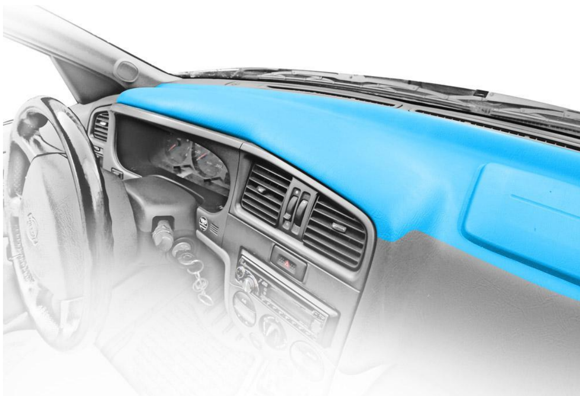
Рисунок 9. Зона предпочтительного размещения ГЛОНАСС/GPS-антенны
