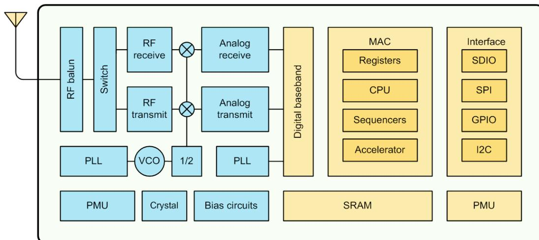
Рис. 3-1. Функциональная блок-схема.
