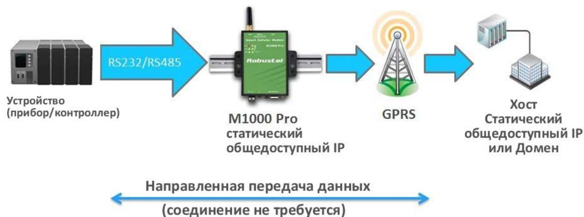
Если Ваш поставщик услуг мобильного доступа к Интернет предоставляет постоянный общедоступный IP-адрес (после соединения с сотовой сетью), то двунаправленный доступ к M1000 Pro v2 с хост-компьютера - по статическому общедоступному IP-адресу.
