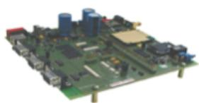
DSB75 - это универсальный комплект для работы с различными GSM модулями Cinterion. Подходит для всех GSM модулей Cinterion производства Gemalto (Thales)
