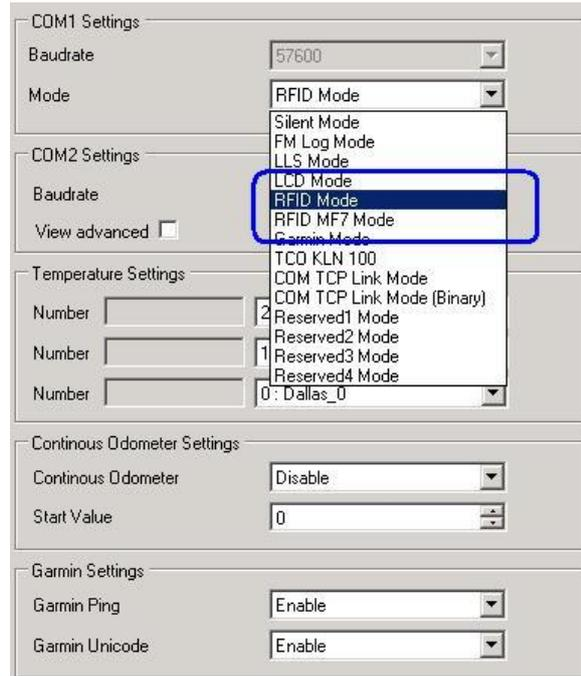
**Figure 66 RFID Global parameter settings**
