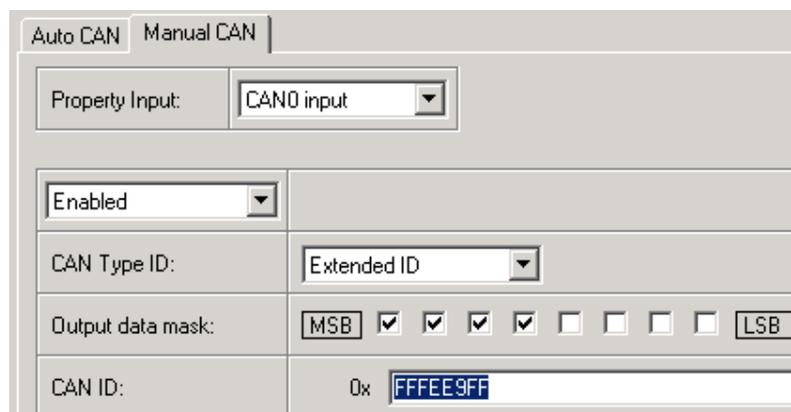
Figure 58 CAN parameter configuration example
