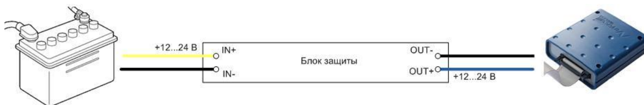
Рис.2 Подключение к бортовой сети и Novacom GNS-ГЛОНАСС)
