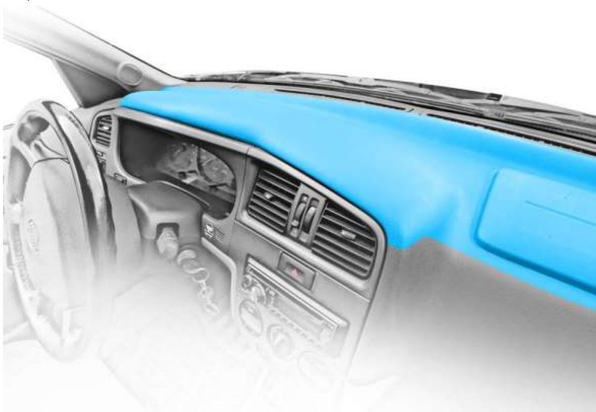
Рисунок 9. Зона предпочтительного размещения ГЛОНАСС/GPS-антенны
