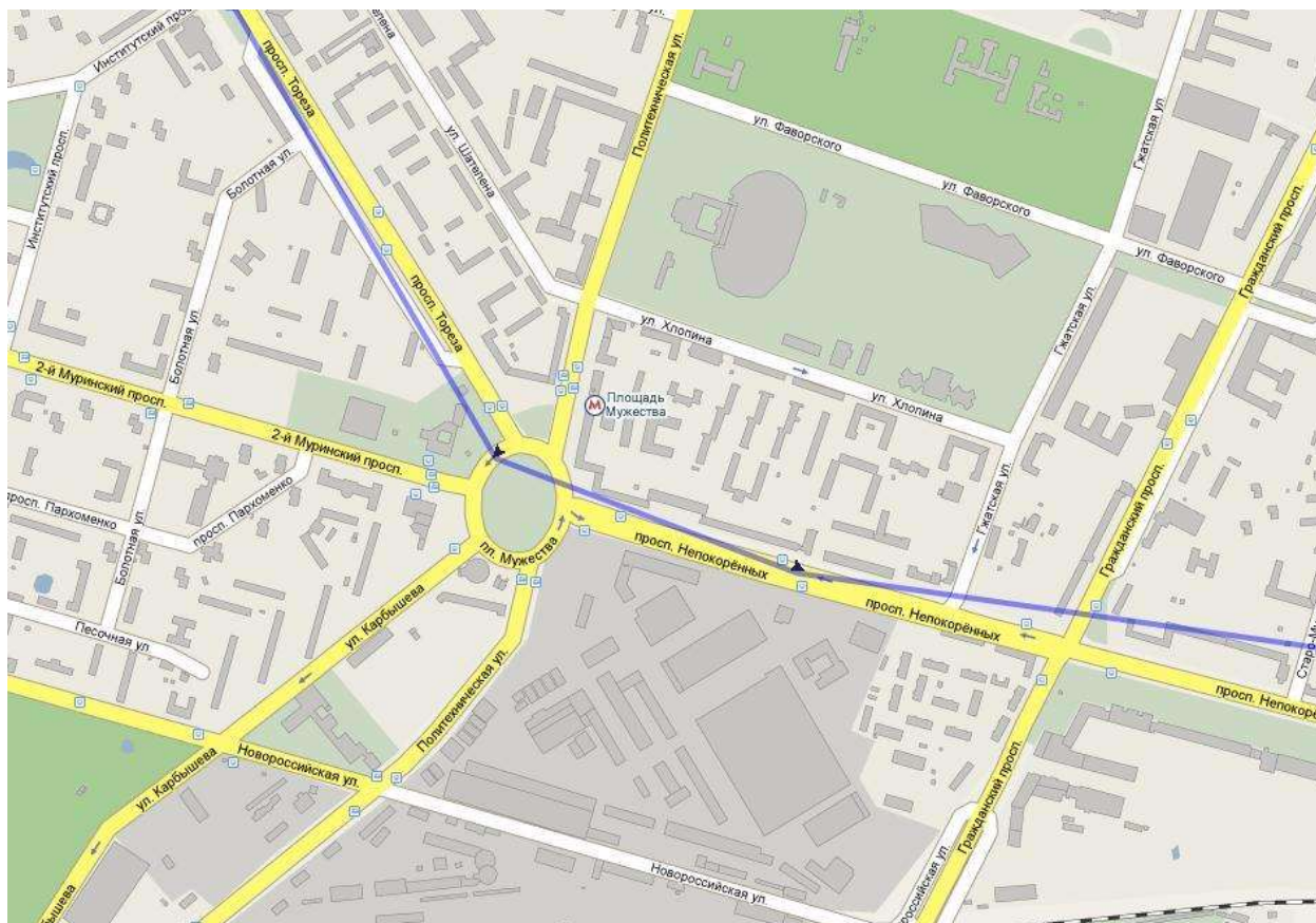
Рисунок 5. Трек движения автомобиля без применения алгоритма интеллектуального трекинга
