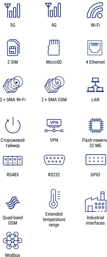
Многофункциональный роутер iRZ RL25w предназначен для передачи данных по сетям сотовой связи. Поддержка LTE, UMTS/HSPA+/EDGE/GPRS обеспечивает высокоскоростной доступ к сети Интернет (прием до 100 Мбит/с, передача до 50 Мбит/с). В устройстве предусмотрена точка доступа Wi-Fi (на базе стандартов IEEE 802.11b/g/n).
