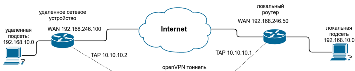
Рис. 3. Примеры конфигураций OpenVPN. Схема сети
