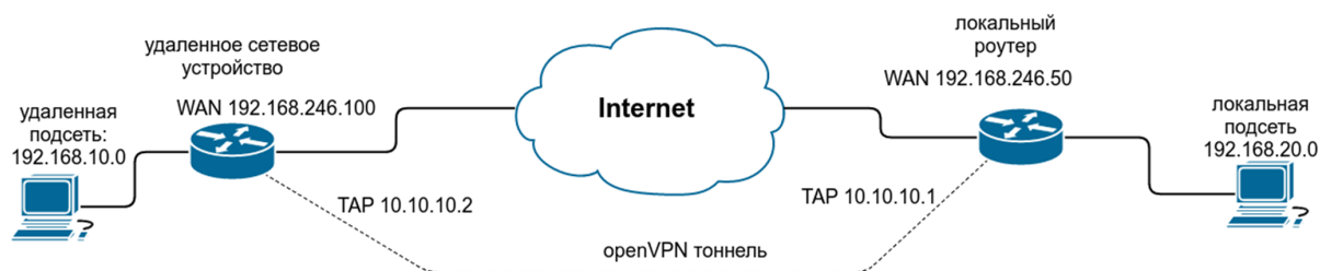
Рис. 9. Примеры конфигураций OpenVPN. Схема сети
