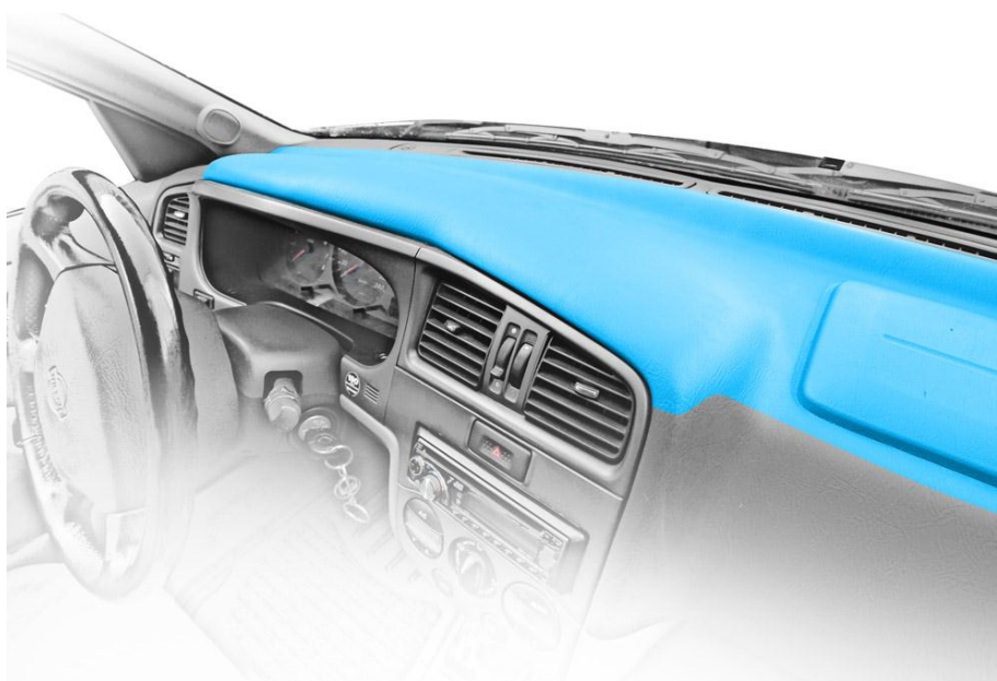
Рис.2.3 Зона предпочтительного размещения ГЛОНАСС/GPS-антенны
