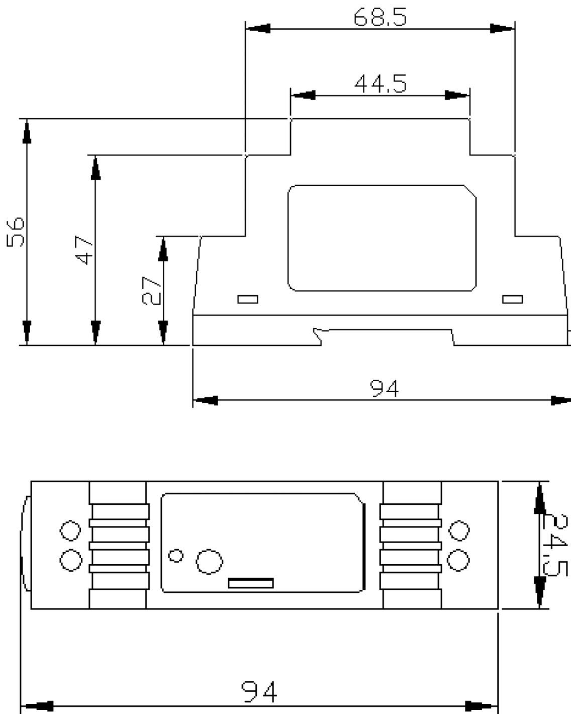
Рисунок 1 Габаритный чертёж блока питания
