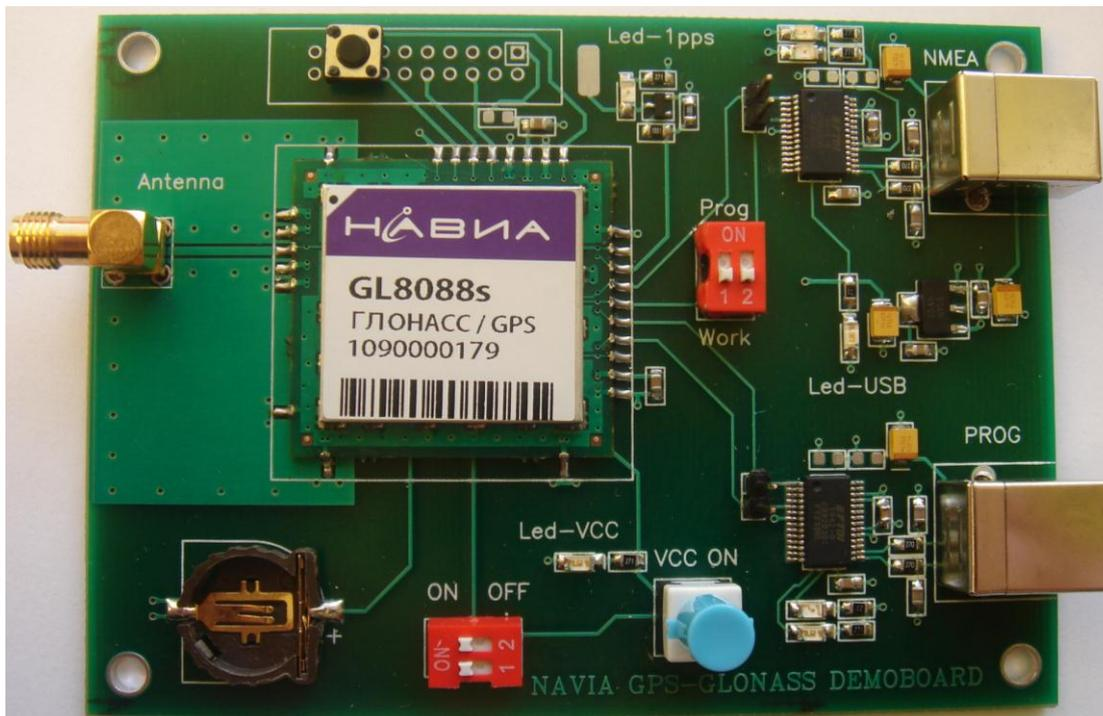
Рис. 2 Внешний вид демонстрационной платы с установленным приемником.
