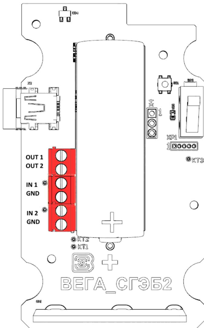
LoRaWAN модем имеет 2 охранных входа. Устройство следит за его замыканием или размыканием, в зависимости от заданных настроек в программе «Vega LoRaWAN Configurator». В случае срабатывания охранного входа, устройство активируется и отправляет в сеть сообщение с сигналом тревоги.
