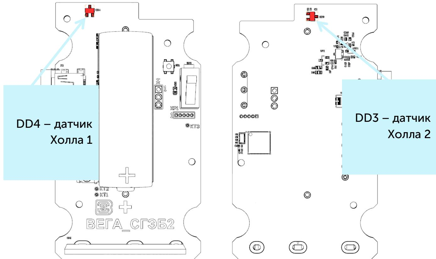
На верхней стороне платы расположен датчик вскрытия корпуса или тампера. При срабатывании датчика Холла 1 и/или тампера в сеть LoRaWAN отправляется пакет с соответствующим сообщением.
