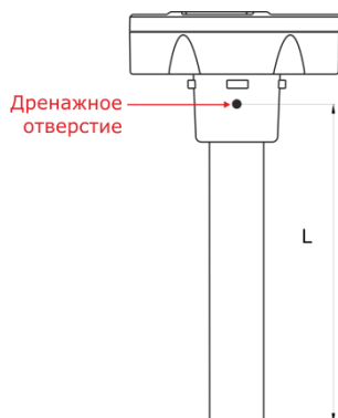
Рисунок 14 — Определение длины измерительной части при калибровке DUT-E S7
