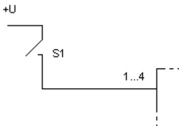
Рис. 11 Подключение датчиков с контактом «на плюс».
