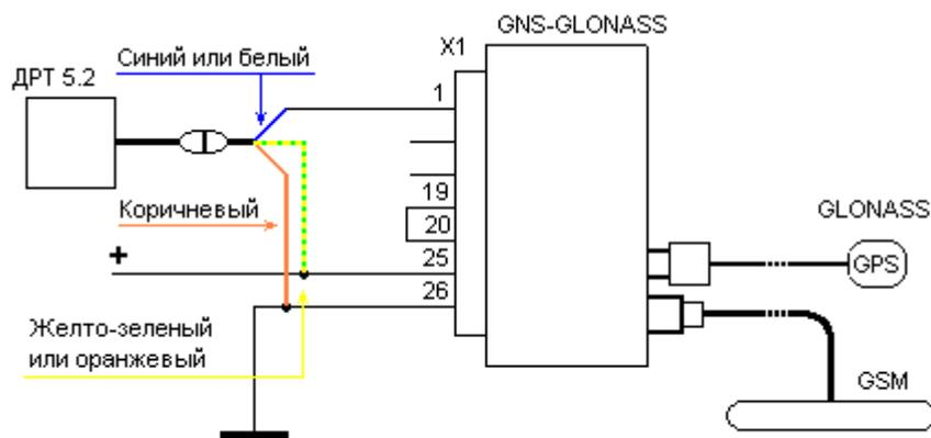
Рис. 12. Пример подключения датчика расхода топлива ДРТ 5.2 к прибору.
