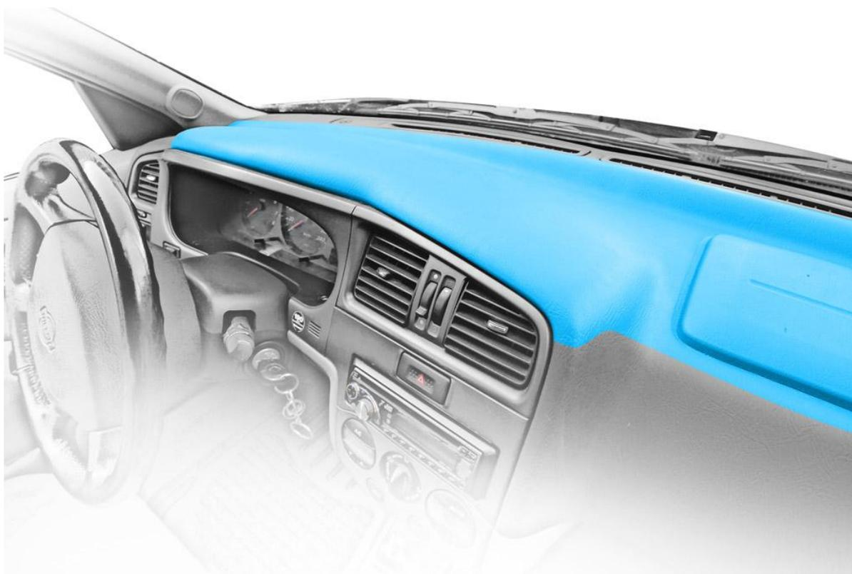
Рис. 9. Зона предпочтительного размещения ГЛОНАСС/GPS антенны.
