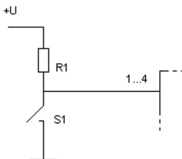
Рис. 10. Подключение датчиков с контактом «на массу».
