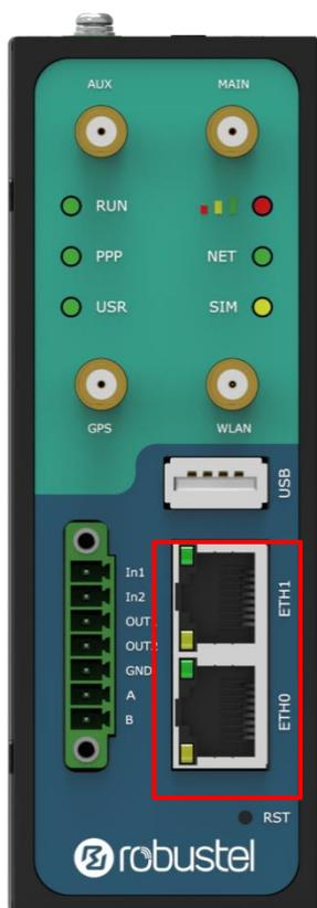
Маршрутизатор R3000 имеет два порта Ethernet, включая ETH0 и ETH1. Каждый порт Ethernet имеет два светодиодных индикатора. Желтый – это индикатор связи, а зеленый – индикатор скорости. Дополнительную информацию о статусе см. в таблице ниже.
