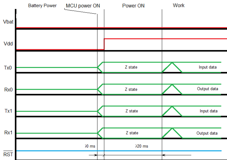
Рис. 7. Временная диаграмма состояний и уровней сигналов на выводах модуля при применении модуля без Vbat.
