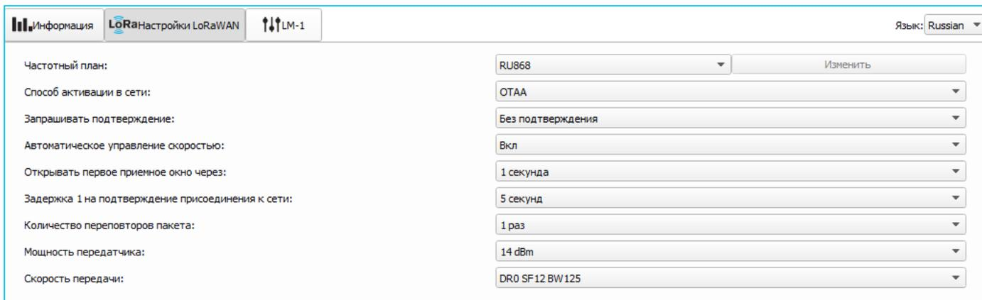
**Частотный план** – позволяет выбрать RU-868, EU-868 или задать *произвольный* частотный план.
