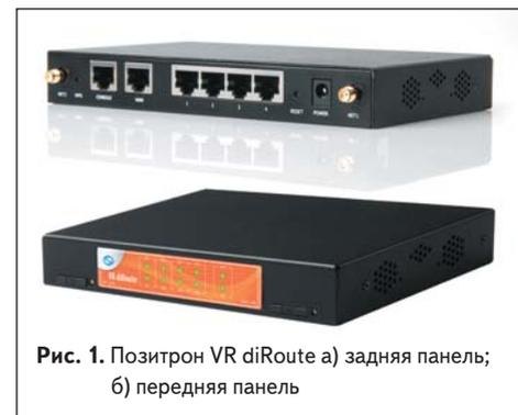
Рис. 1. Позитрон VR diRoute а) задняя панель; б) передняя панель
