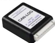
Модуль CAN-LOG преобразовывает и дешифрует данные, подключаемые с CAN-шины автомобиля. Согласуется с ней на программном и аппаратном уровне. Используется для оптимизации установки систем контроля над параметрами автомобилей, оборудованных цифровой шиной CAN. Позволяет считывать требуемую информацию.
