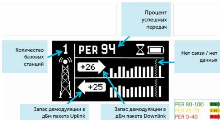
**Рабочий экран №1:** Запас демодуляции сигналов Uplink и Downlink
