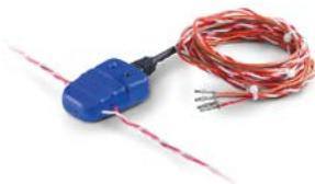
Получает данные о работе автомобиля из шины CAN без вмешательства в целостность самой шины. Считывание данных без электрического контакта с проводами. CANCrocodile применяется для подключения к шине CAN систем ГЛОНАСС/GPS мониторинга, которые получают информацию о режимах работы двигателя, состоянии датчиков, наличии неисправностей и т.д. Не нарушает изоляцию проводов CAN и «слушает» обмен по шине с помощью специального беспроводного приёмника.
