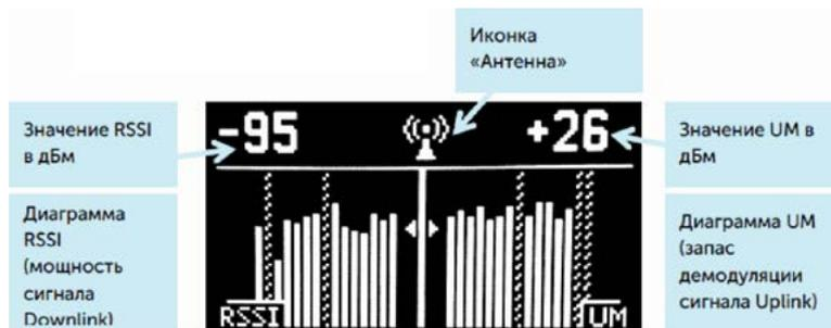
**Рабочий экран №3:** Диаграммы RSSI сигнала Downlink и запаса демодуляции сигнала Uplink
