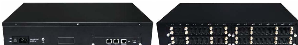
Dinstar DWG2000G-32G-128 SIM — многофункциональный GSM/3G VoIP шлюз, предназначенный для детерминации трафика между мобильными и VoIP-сетями.
