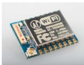
ESP-07 Память SPI flash 1 МБ Форм-фактор, мм 16x21.2x3
