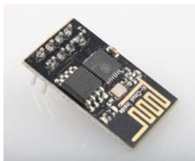
ESP-01 Память SPI flash 1 МБ Форм-фактор, мм 14.3x24.8x3
