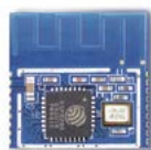
ESP8285 (Wi-Fi-чип) flash-память 1МБ
