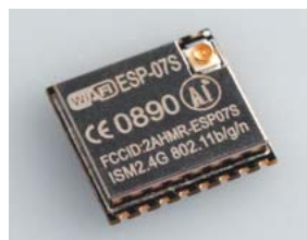
ESP-07S IPEX-интерфейс для подключения внешней антенны Форм-фактор, мм 18x20x3
