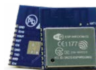
ESP WROOM-02 (Wi-Fi-модуль) Размер: 18 x 20 мм, корпус с торцевыми контактами, встроенной антенной и разъёмом для подключения внешней антенны
