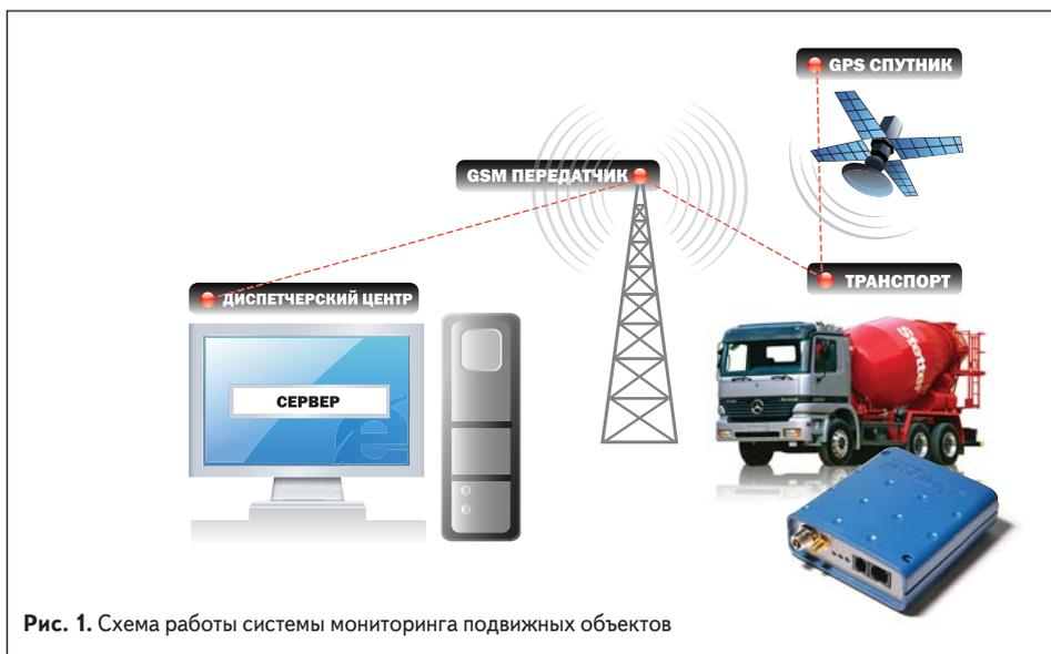
Рис. 1. Схема работы системы мониторинга подвижных объектов
