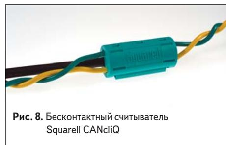
Рис. 8. Бесконтактный считыватель Squarell CANcliQ
