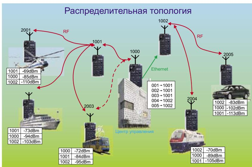
Рис. 5. Распределенная топология сети передачи данных MORSE
